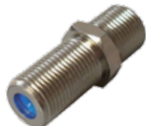
FB 03 F-Buchse auf F-Buchse lange Ausführung, für Erdungsschienen geeignet, hohe Rückflusdämpfung, (5-65 MHz > 50 dB, 65-865 MHz > 40 dB, 950 – 2500 MHz > 30 dB)
